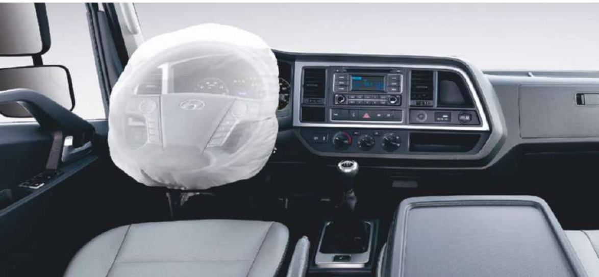
Жүргізушінің қауіпсіздік жастығы Ауыр жарақат алу қаупін азайтады.
